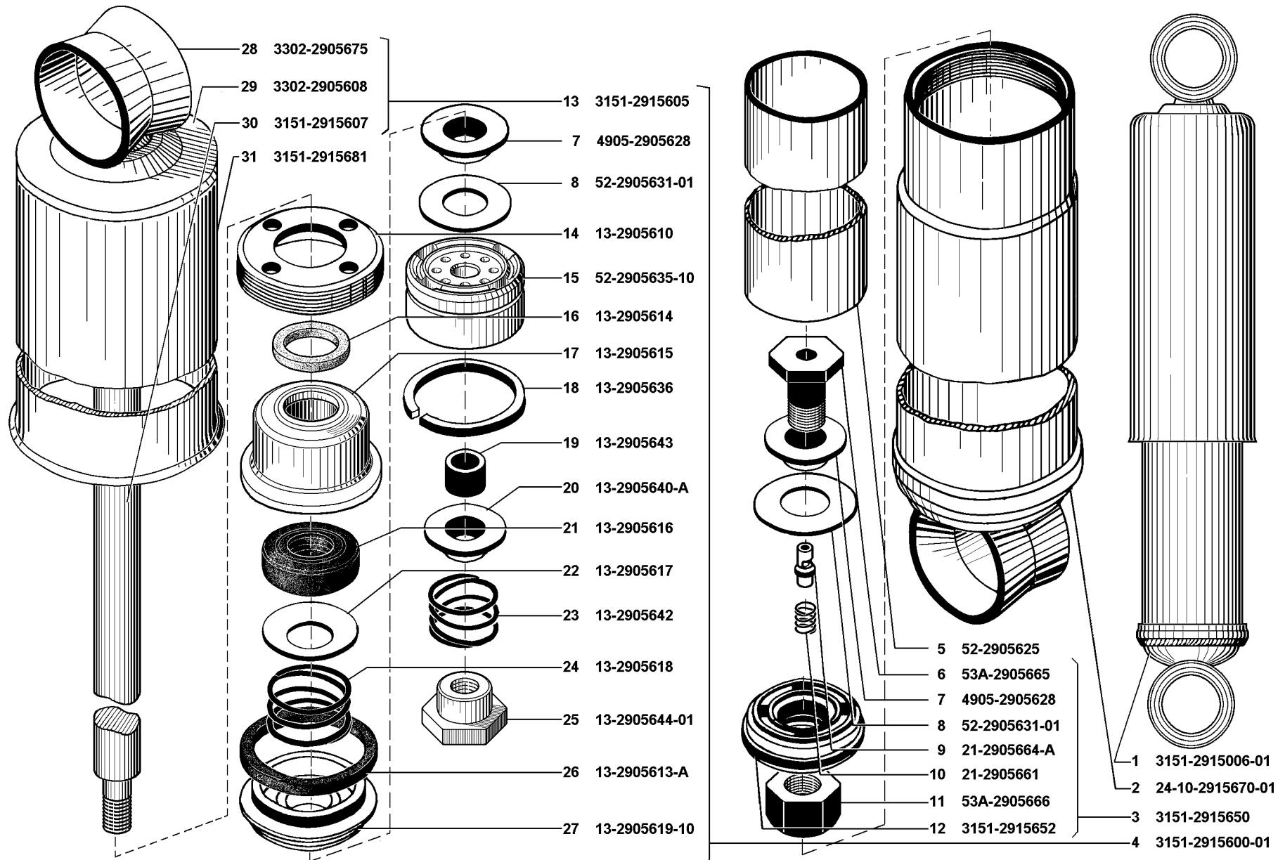
Рис. 67. Амортизаторы задние (2915)/1
